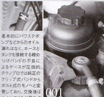
基本的にパワステポンプなどからのオイル漏れではなく、ホースとタンクを接続する締めつけバンドの不良によるケースが圧倒的。テクニカルでは純正のクリップ式バンドからボルト式のモノへと変更しており、交換後はオイルにじみが発生することもないから。さほど高いパーツでもないだけに、できればすべてのバンドをボルト式へとあらためておきたいところ。週末を利用してのDIYも可能
