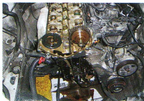
写真はW210型E240のオイル漏れ修理の様子。近隣にある第二ファクトリーにて修理を行っており、近くに住むユーザーも気軽に利用中だ。
